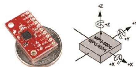
**Fig. 4:** MPU6050 accelerometer module
